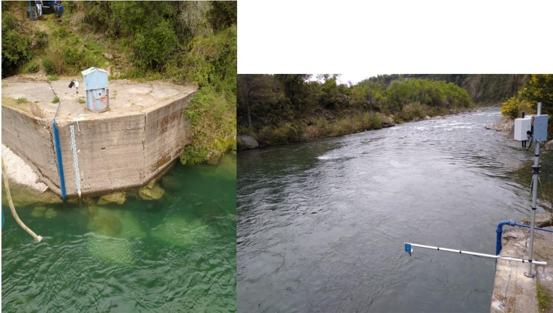
**Figura 18. Estación fluviométrica instalada en Longaví en el Castillo**
