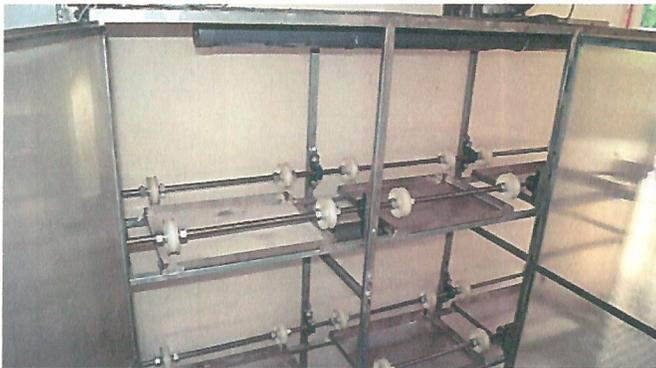
Foto 5. Detalle del interior del equipo que hace girar los cilindros con polillas para colectar los huevos (método alemán)
