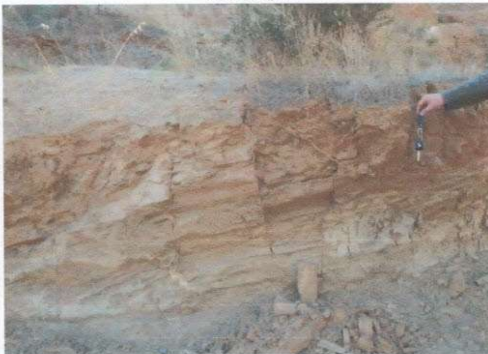
FIGURA N° 3-9 Afloramiento de basamento metamórfico, con desarrollo de meteorización en el límite sur de Curepto
